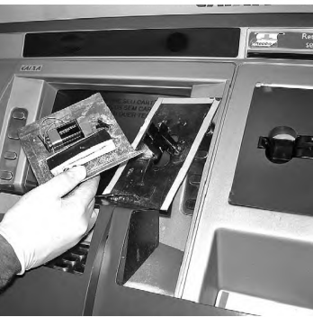
Caixa eletrônico da Caixa Federal em que ladrões instalaram placa e câmera
