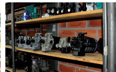
Quando uma peça de freio chega para manutenção, ela passa por várias etapas. A primeira delas é a limpeza para retirada do óleo e algum tipo de sujeira impregnada. Num segundo momento, essa peça é desmontada por um mecânico especializado em corrigir eventuais problemas. Consertada, a peça passa por uma máquina de teste e pode voltar a ser utilizada.
