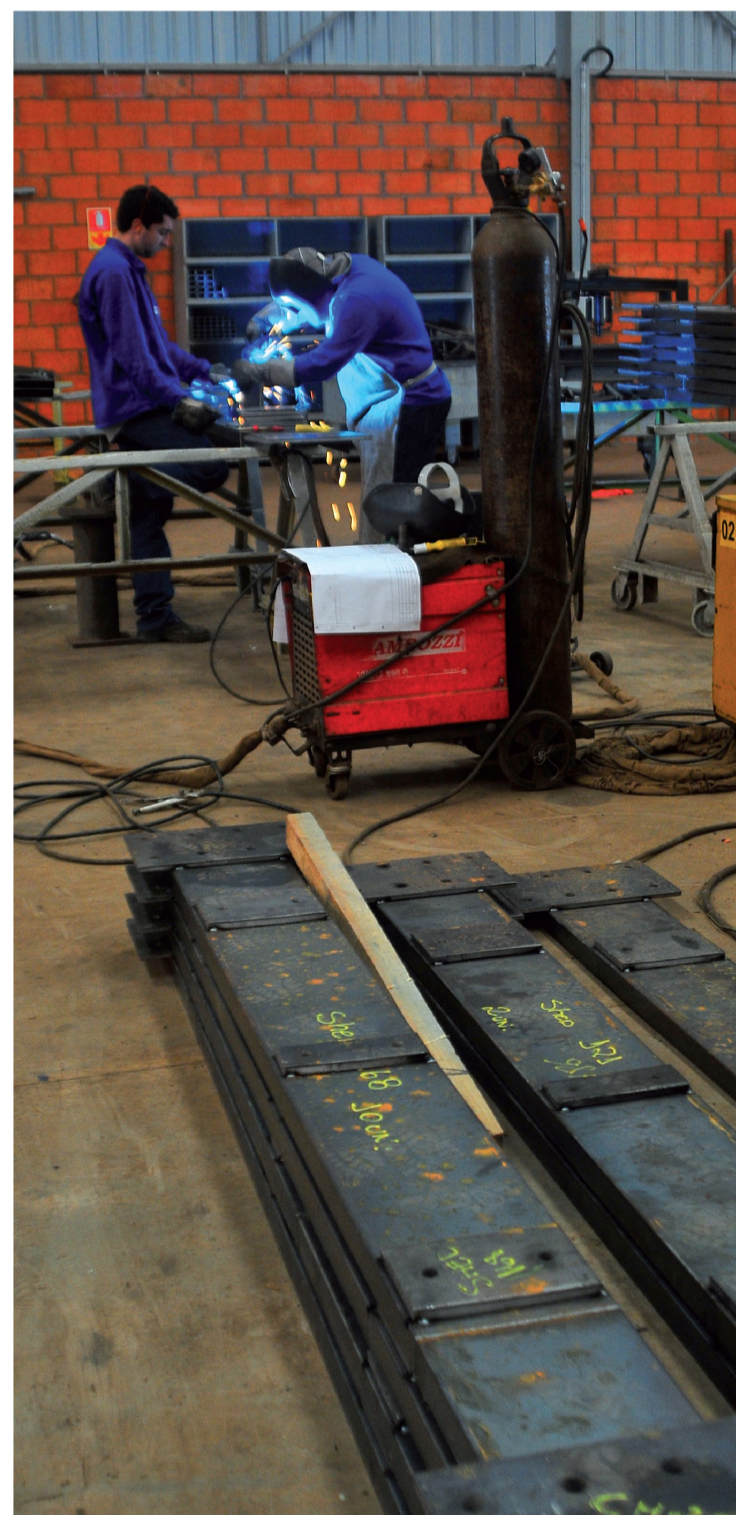
Junção das peças é feita basicamente por soldagem: rigidez nos detalhes
