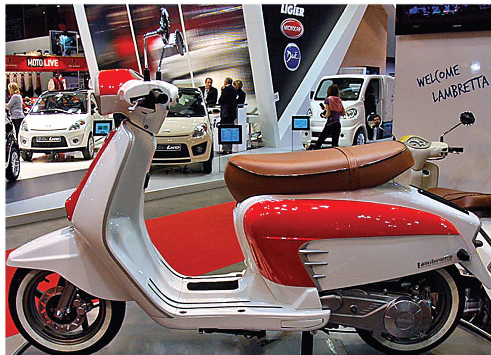
A Lambretta voltou com rodas de 12 polegadas, partida elétrica e injeção eletrônica
