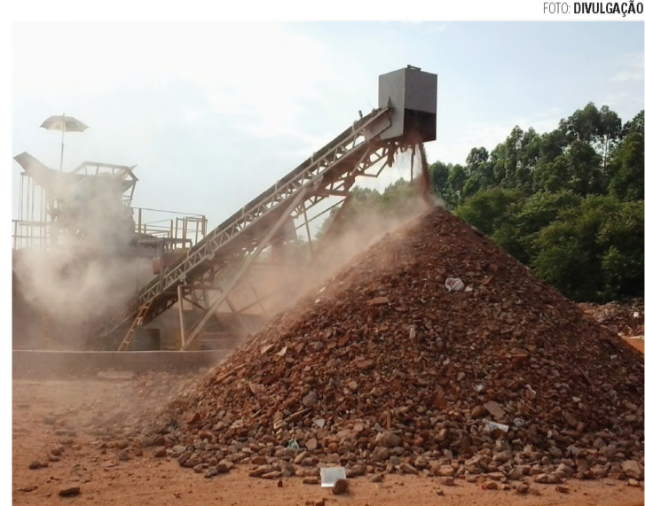
USINA - Capacidade de processamento da Usina é de 20 toneladas/hora
