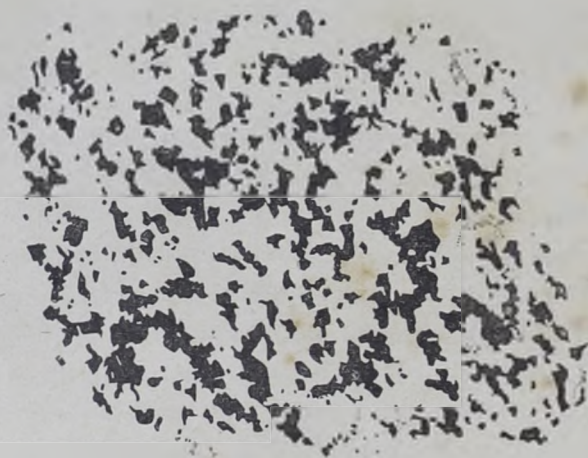
Fig. 28. — Disposição do quartzo (parte negra), na massa do granito commum.
