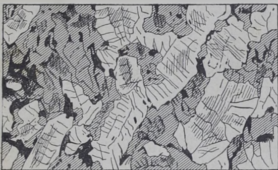
Fig. 24. — Textura granítica (do granito egypcio). — As superficies cobertas de traços finos representam o quartzo; o preto figura a mica; o mais corresponde ao feldspatho.
