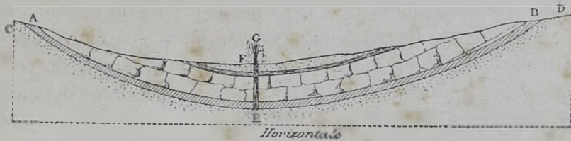
Fig. 9. — Lençol esguichante. — AB, camada impermeavel; CD, camada d'agua; EF, poço artesianano.
