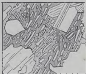
Fig. 27. — Microlithos de feldspatho na pasta de um porphyrito.
