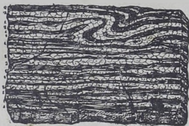
Fig. 39. — Gneiss commun. — 1. Filas de quartzo e de feldspatho. — 2. Leitos de mica.
