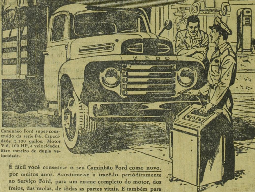
Caminhão Ford super-construído da serie F-6. Capacidade 5.100 quilos. Motor V-8, 100 HP, 4 velocidades. Eixo trazeiro de dupla velocidade.
