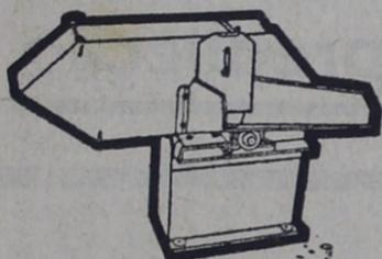
(Moi, cana, capim, milho, tubá etc. - para rações de gado ou aves. Baixa demanda de força. Funciona com motor elétrico, a gasolina, diesel ou de tratores. Grande simplicidade. Construção inteiramente metálica, de grande robustez).
