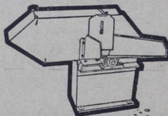
(Mói cana, capim, milho, fubá etc - para rações de gado ou aves. Baixa demanda de força. Funciona com motor elétrico, a gasolina, diesel ou de tratores. Grande simplicidade. Construção inteiramente metálica, de grande robustez).
