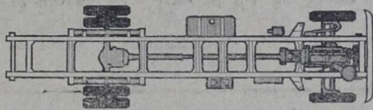
Um comprimento de chassi para cada finalidade. Curto (D-6403), para manobra em espaço exiguo, indica-se também como cavalo-mecânico, basculante, etc. Carga pesada e de pequeno volume é com o médio (D-6503). Agora, se Você detesta erguer montanhas de fardos e caixotes, veja quanta carga cabe na carroçaria do longo (D-6803)!
