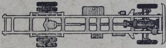
Um comprimento de chassi para cada finalidade. Curto (D-6403), para manobra em espaço exiguo, indica-se também como cavalo-mecânico, basculante, etc. Carga pesada e de pequeno volume é com o médio (D-6503). Agora, se Você detesta erguer montanhas de fardos e caixotes, veja quanta carga cabe na carroçaria do longo (D-6803)!
