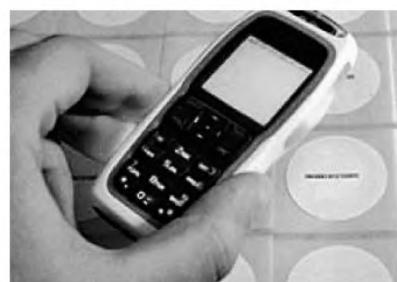
» PAGAMENTOS A Nokia apresentou o protótipo 3220 NFC, que tem leitor e é capaz de imprimir informações por sistema de identificação por radiofrequência (RFID), que substituirá o código de barras
