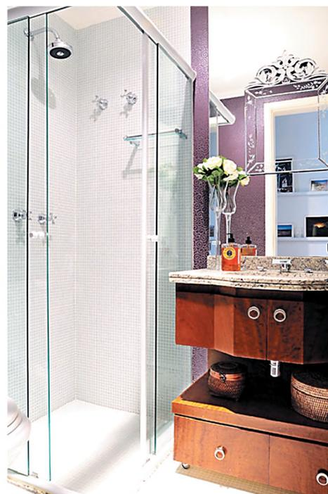
**DESAFIO C | BANHEIRO** | As pastilhas do banheiro foram instaladas sobre o revestimento anterior e, no espaço destinado ao papel de parede, foi aplicada apenas uma massa para nivelar. Os metais também foram trocados e, sobre o espelho, as arquitetas aplicaram um modelo veneziano.
