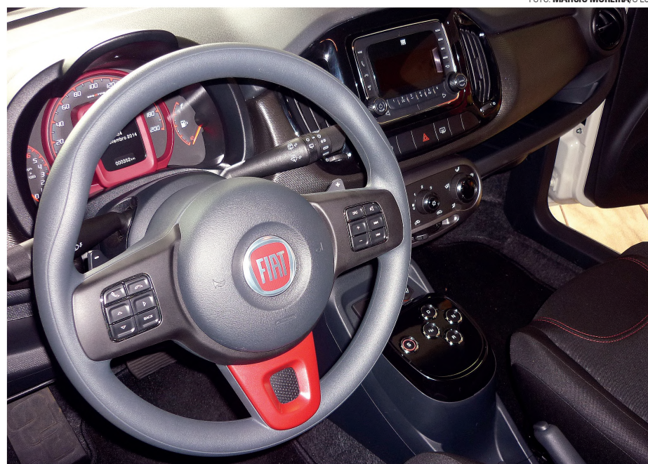
UNO 2015 – Parte interna do modelo Sporting com câmbio Dualogic Plus e display LCD
