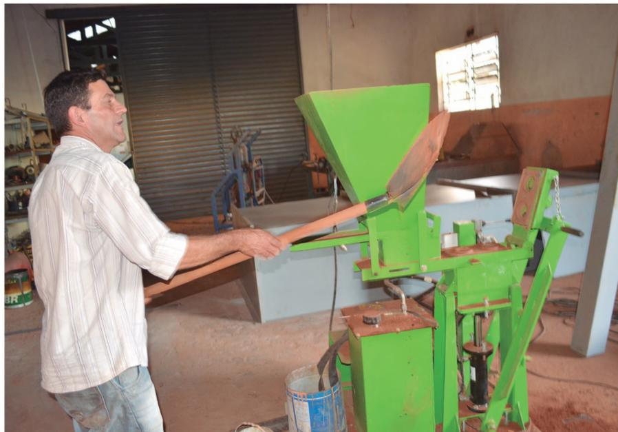
**PROCESSO** – Fábrica que utiliza resto de material de construção para fazer tijolo é equipada com prensa, misturador, esteira transportadora, tanque de imersão e cavaletes
