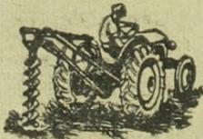
Faz de 600 a 1.000 buracos por dia. Brocas de diferentes tamanhos e tipos. Buracos para postes de cerca e iluminação, covas para plantio e adubação de café, para retenção de águas pluviais, etc.
