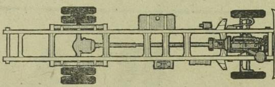
Um comprimento de chassi para cada finalidade. Curto (D-6403), para manobra em espaço exiguo, indica-se também como cavalo-mecânico, basculante, etc. Carga pesada e de pequeno volume é com o médio (D-6503). Agora, se Você detesta erguer montanhas de fardos e caixotes, veja quanta carga cabe na carroçaria do longo (D-6803)!
